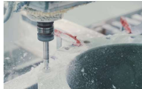
Drilling of flanges Perçage des brides
