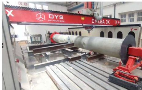
Drilling of manifold Perçage du collecteur
